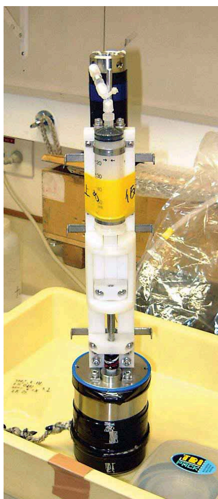
写真1 微量熱水採取器 (自己記録式温度計と組み合わせての使用例)
