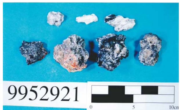
写真10 アクティブチムニー先端部の硬石膏結晶 Photo 10 Anhydrite on the top of a active chimney.
