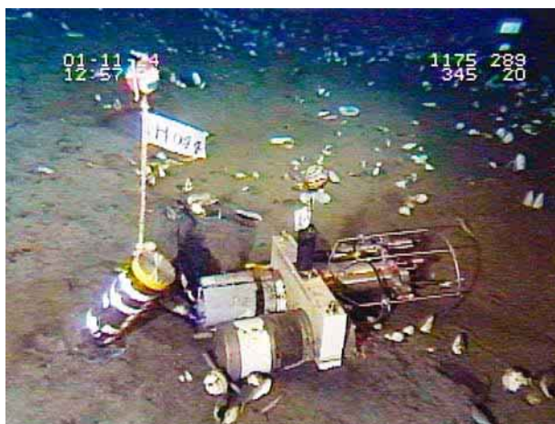
図4 図3の★地点に設置されたメタンセンサ付きCTDセンサ(右)と地中温度計(左)
