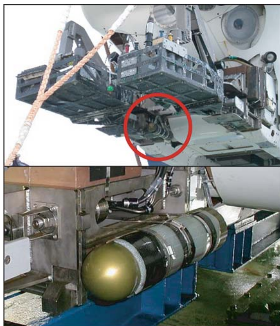
図9 「しんかい6500」の右側サンプルバスケットの根元に搭載されたガンマ線センサ
